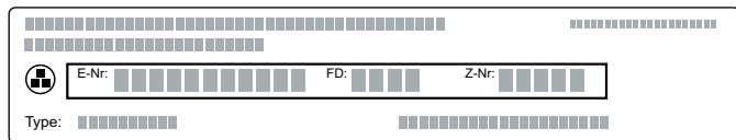
Номер изделия (номер E) указан также на стеклокерамической поверхности варочной панели. Вы можете проверить список сервисных центров (КИ) и заводской номер (номер FD), зайдя в меню базовых установок. См. главу → "Базовые установки".
