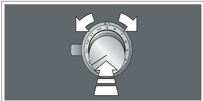
Выбранная ступень нагрева отображается на индикаторе конфорки. Световое кольцо регулятора загорается.
