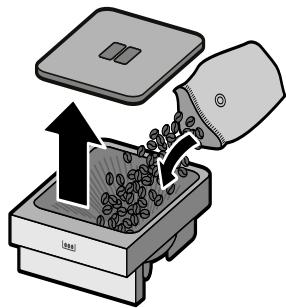
**Указание:** Глазированные, карамелизованные или обработанные другими содержащими сахар добавками кофейные зерна приводят к забивке заварочного блока. Используйте только смеси кофейных зерен, предназначенные для полностью автоматической кофемашины.
